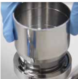
1. 连轴底座与不锈钢杯快速连接
